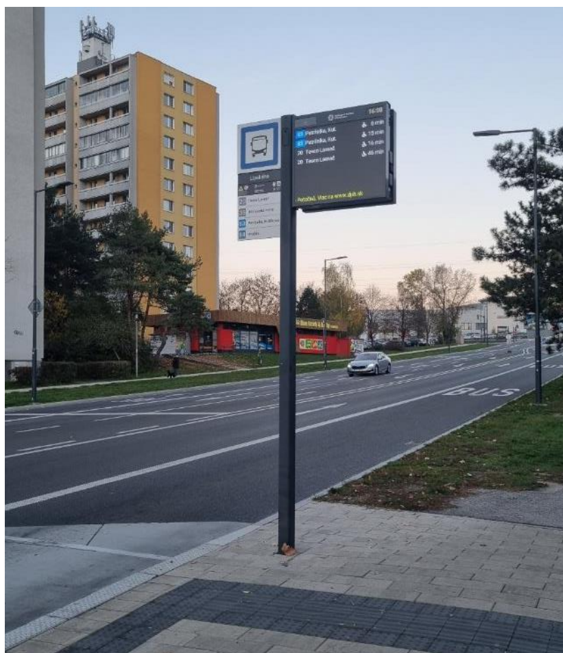
Obrázok 126_Príklad EIT osadenej na zastávkovom stĺpiku s označníkom; zastávka Lipského
